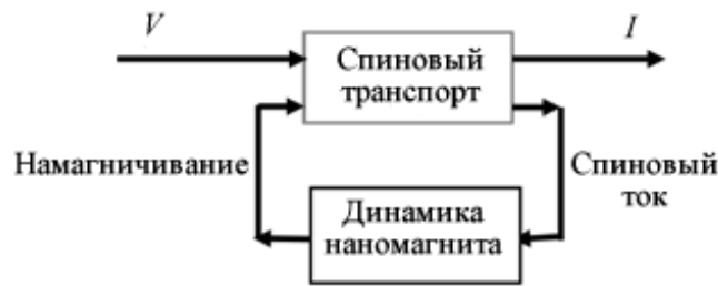
Рис. 14 – Спиновый транспорт и динамика перемагничивания наномagnитов тесно связаны.
